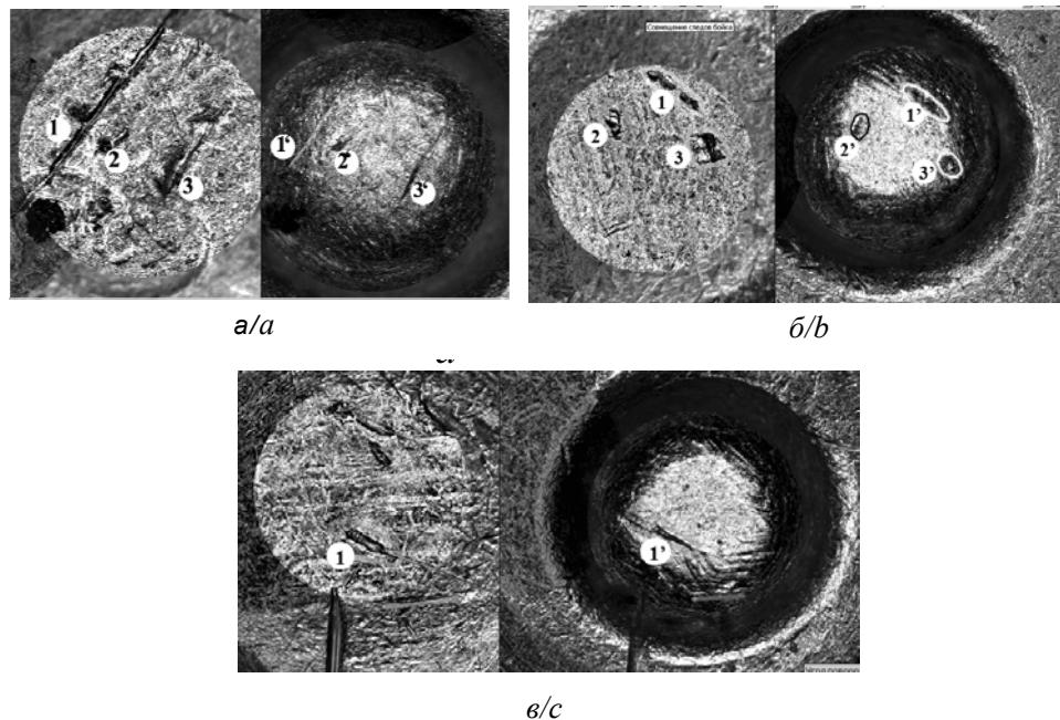
Рис. 3. Отображение неоднородностей поверхности капсюля (патроны  $5.6 \times 39$  мм,  $P_{\max} = 2000$  атм) в следе бойка после полноценного выстрела (слева изображения шероховатостей на поверхности капсюлей до выстрела, справа изображения следов бойка с частично сохранившимися шероховатостями поверхности капсюля): *a* – шероховатости в виде про-
