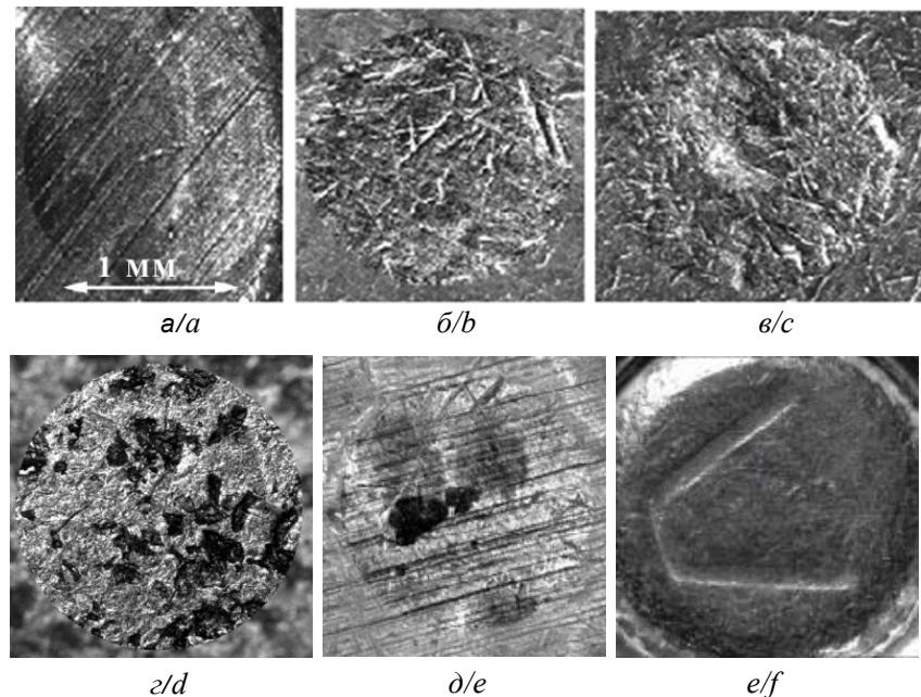
Рис. 1. Характерные шероховатости и неоднородности поверхности капсюлей патронов: *а* – трассы от прокатки фольги колпачка капсюля; *б* – крупные борозды, углубления, вмятины; *в* – относительно мелкие борозды, углубления, вмятины; *г* – каверны; *д* – пятна коррозии неопределенной формы; *е* – объемная маркировка на капсюле
