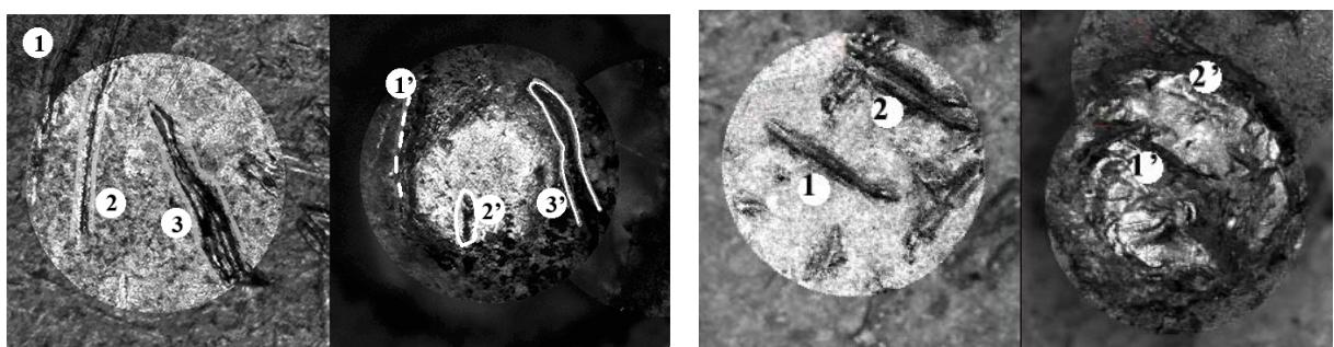
Рис. 4. Отображение неоднородностей поверхности капсюля ( $P_{\max} \approx 750$  атм.) в следе бойка после полноценного выстрела (слева изображения шероховатостей на поверхности капсюлей до выстрела, справа изображения следов бойка с частично сохранившимися шероховатостями поверхности капсюля)
