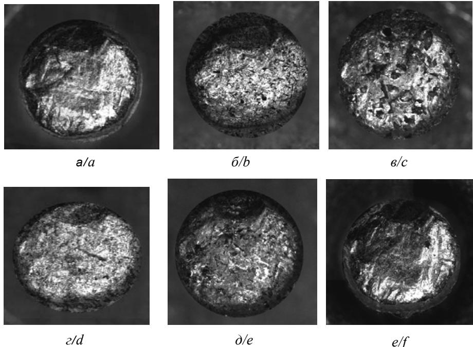
Рис. 2. Следы одного бойка: *а* – на новом капсюле без шероховатостей на рабочей поверхности; *б* – на новом капсюле с шероховатостью в виде каверн размером 30–70 мкм; *в* – на новых капсюлях с кавернами в виде темных пятен размерами 70–130 мкм; *г* – на старых капсюлях с пятнами окисления в виде темных пятен; *д* – на старых капсюлях с шероховатостью в виде каверн размером 70–130 мкм; *е* – на фольге толщиной 200 мкм
