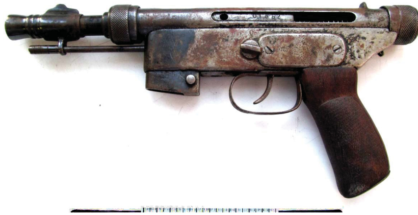
Рис. 3. Вариант конструктивно сходных с пистолетом-пулеметом К6-92 самодельного пистолета-пулемета «Борз» под патрон 9×18 мм (ПМ)
