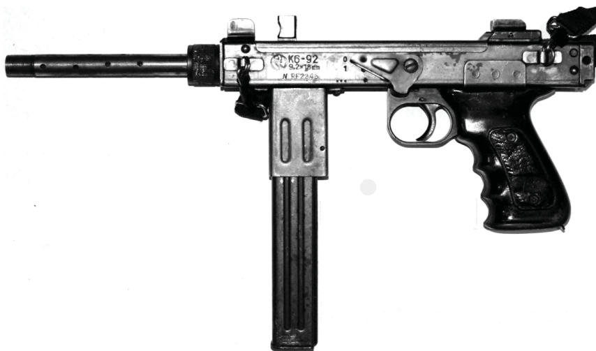
Рис. 2. Технологические отверстия и участок резьбы на стволе пистолета-пулемета К6-92
