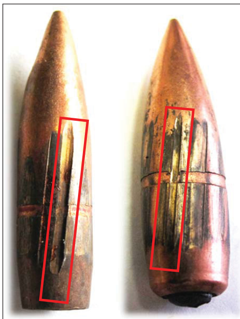
Рис. 4. Следы на пуле от штифта, установленного в канале ствола
