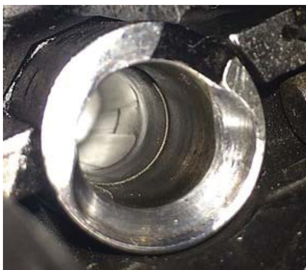
Рис. 2. Выточка в канале ствола самозарядного карабина МА-ПП-91, изготовленного на базе пистолета-пулемета ПП-91 «Кедр» Fig. 2. Recess in the bore of the self-loading carbine MA-PP-91, made on the basis of the submachine gun PP-91 Cedar
