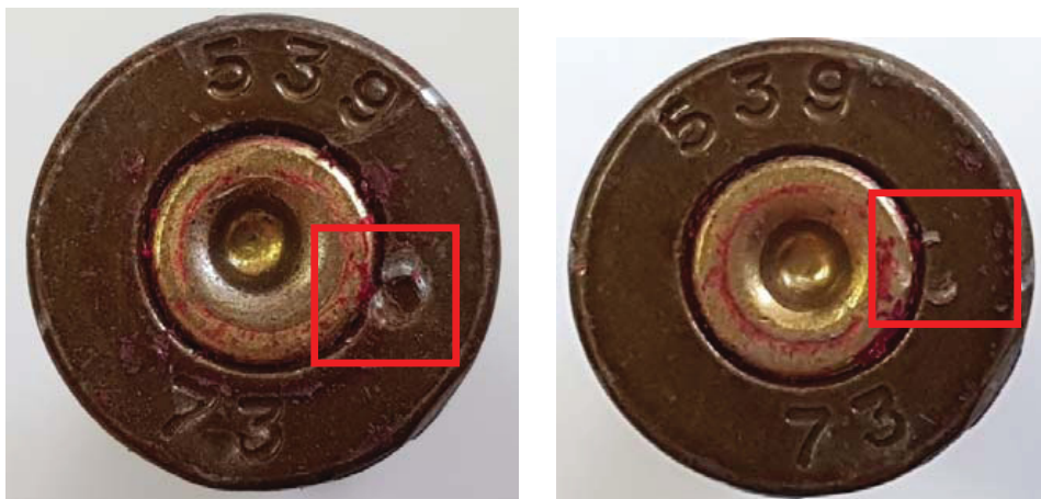
Рис. 3. Варианты отображений следов на донной части гильзы от штифта, выполненного на патронном упоре затвора
