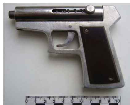
Рис. 2. Общий вид однозарядных пистолетов под патрон калибра 5,6 мм Fig. 2. General view of single-shot pistols chambered for 5.6 mm caliber
