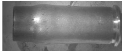
Рис. 4. Бутылочная форма гильзы спортивного пистолетного патрона калибра 7,62 мм, штатного к ТОЗ 49, после выстрела из пистолета «Маузер К 96» образца 1896 г.
