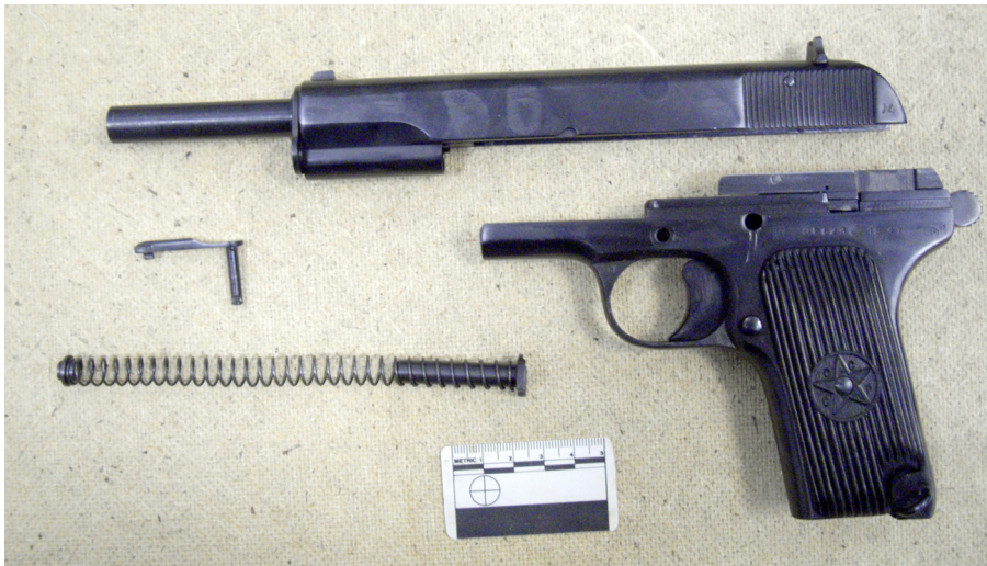
Рис. 1. Пистолет МР-81 в частично разобранном виде
