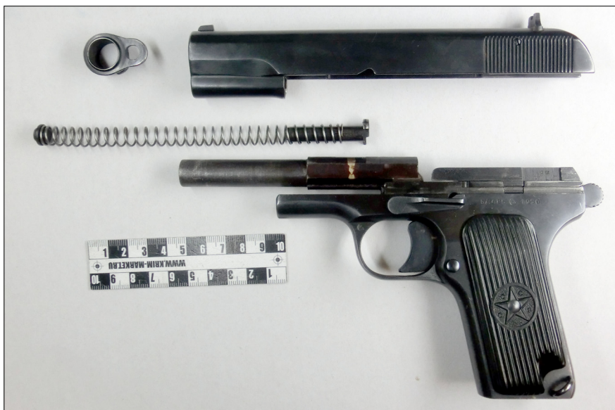
Рис. 3. Пистолет «ВПО-509 – Лидер-М» в частично разобранном виде
