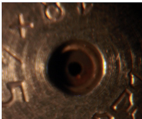
Рис. 1. Сквозное прогорание электроискрового разрядника травматического патрона 18×45Т под действием электрического импульса схемы воспламенения пистолета «Оса ПБ-4-1»
