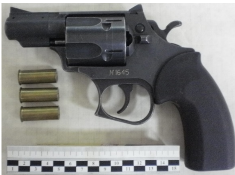
Рис. 2. Общий вид использованного для проведения баллистических экспериментов револьверного 12,3 мм комплекса «Удар» (ЦНИИТОЧМАШ) Fig. 2. General view of the Blow complex (TsNIITochMash) used for carrying out ballistic experiments of revolving 12,3 mm
