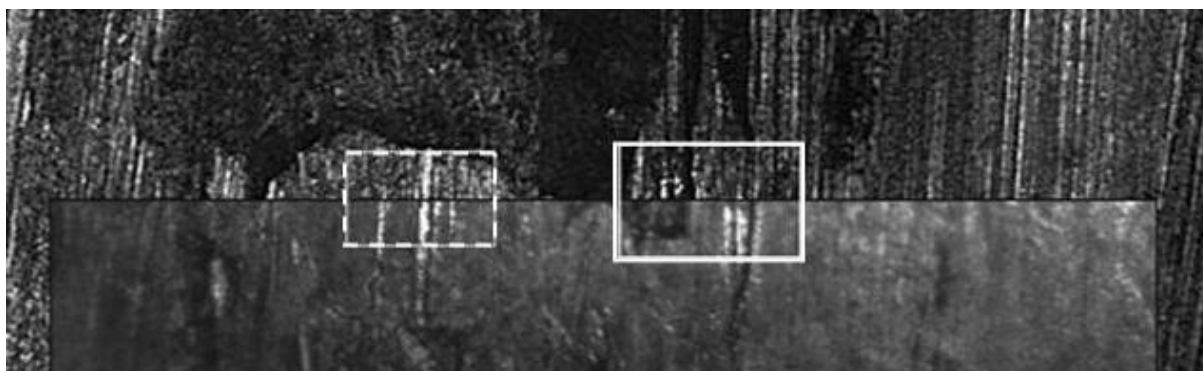
Рис. 3. Совмещение изображения недеформированной и деформированной пули (сплошной линией показана область не совместившихся трасс, а пунктиром – совпавшая область)
