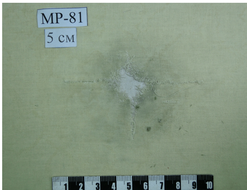
Рис. 5. Экспериментальная мишень. Повреждение, образованное при выстреле из пистолета MP-81 с дистанции 5 см от дульного среза ствола пистолета до мишени
