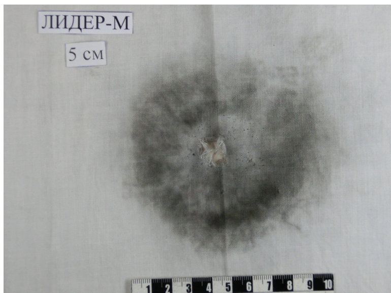
Рис. 6. Экспериментальная мишень. Повреждение, образованное при выстреле из пистолета «ВПО-509 – Лидер-М» с дистанции 5 см от дульного среза ствола пистолета до мишени
