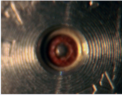
Рис. 3. Отсутствие сквозного прогорания электроискрового разрядника травматического патрона 18×45Т под действием электрического импульса схемы воспламенения пистолета «Стражник МР-461»
