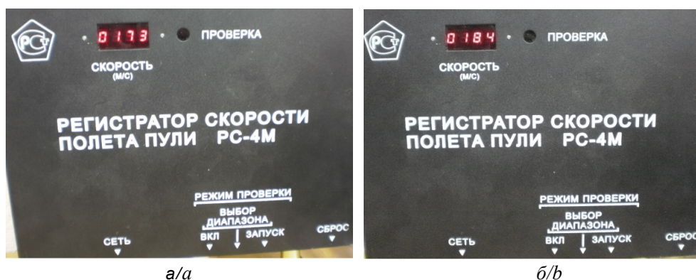
Рис. 3. Значения скорости полета снарядов, зафиксированные с помощью РС-4М, при проведении отстрела партии из 10 штук снаряженных патронов: a – минимальная скорость, b – максимальная скорость
