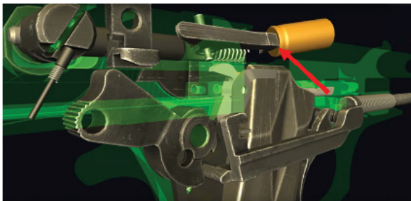
Рис. 7. Схема эжекции гильзы из пистолета Beretta 92 FS (стрелкой показан следовой контакт) (цвет online)
