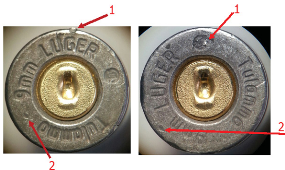
Рис. 3. Следы кончика бойка и отражателя на дне гильз, стрелянных в пистолете Glock 17, образованные при максимальном темпе стрельбы (слева) и при стрельбе с интервалом 2 с и более (справа): 1 – след кончика бойка, 2 – след отражателя
