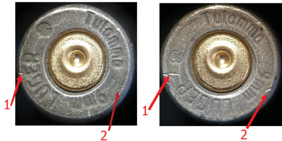
Рис. 8. Вариационность в следах отражателя и передней части зацепа выбрасывателя на гильзах, стрелянных в пистолете Beretta 92 FS, при различных темпах стрельбы. Слева – гильза, стрелянная при максимальном темпе стрельбы, справа – гильза, стрелянная при стрельбе с интервалом 2 с и более: 1 – след отражателя, 2 – след передней части зацепа выбрасывателя
