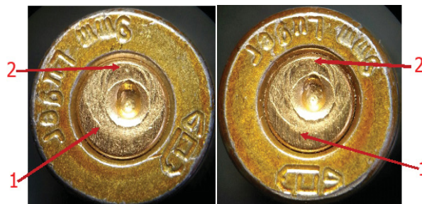
Рис. 11. Вариационность в следах обработки патронного упора и следа кончика бойка, не связанного с наколом капсюля, на гильзах, стрелянных в пистолете МР-446 «Викинг», при различных темпах стрельбы. Слева – гильза, стрелянная при максимальном темпе стрельбы, справа – гильза, стрелянная при стрельбе с интервалом 2 с и более: 1 – след обработки патронного упора, 2 – след кончика бойка
