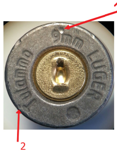
Рис. 2. Следы на дне экспериментальной гильзы, стрелянной в пистолете Glock 17: 1 – след кончика бойка, 2 – след отражателя
