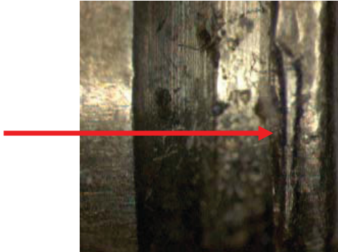
Рис. 1. След зацепа выбрасывателя на фланце переснаряженной гильзы калибра .300 win mag Fig. 1. The trace of extractor horn on the liner flange of the .300 win mag caliber reloaded case
