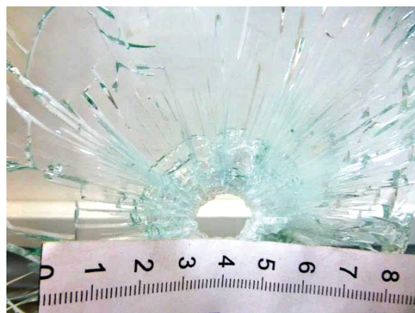
Рис. 3. Повреждение 3 стекла № 1 картечью с расходящимися от краев радиальными и концентрическими трещинами
