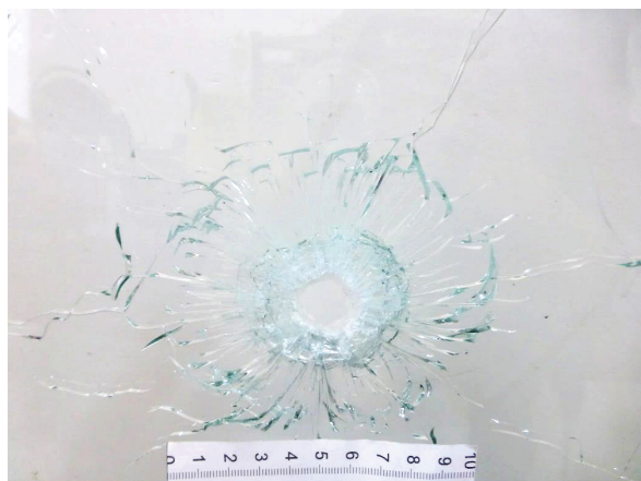
Рис. 1. Сквозное повреждение 1 стекла № 1 пулей с расходящимися от краев радиальными и концентрическими трещинами
