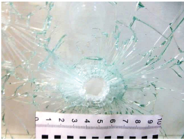
Рис. 4. Повреждение 4 стекла № 1 картечью с расходящимися от краев радиальными и концентрическими трещинами
