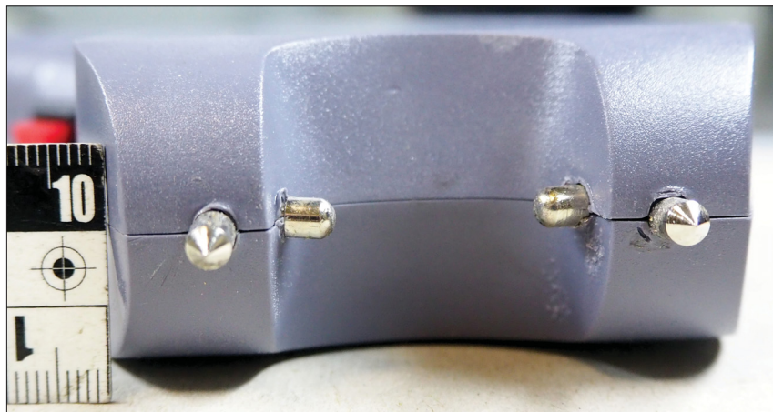
Рис. 3. Вид и взаиморасположение внешних электродов электрошокового устройства «ЭШУ-300»
