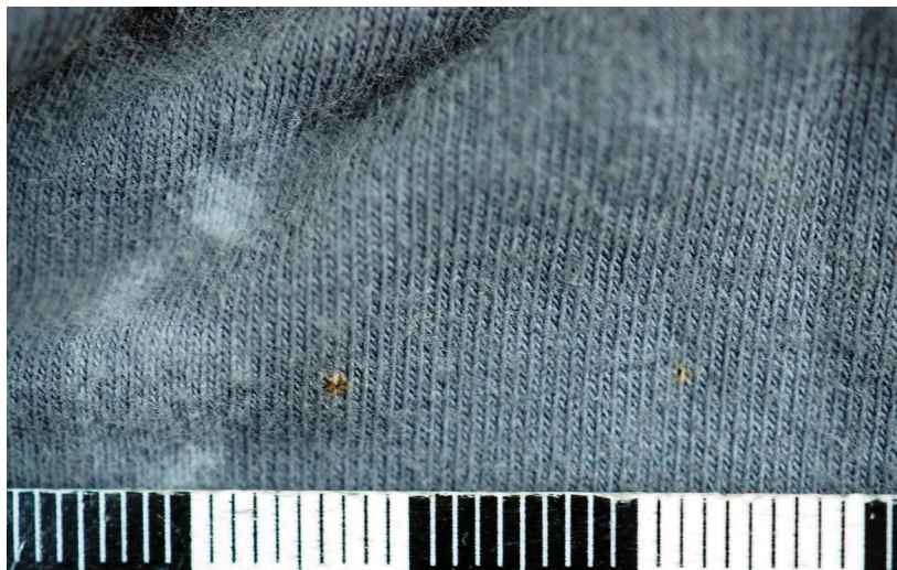
Рис. 4. Экспериментальное повреждение, образованное при воздействии на материал предмета одежды (трусов) контактами-электродами электрошокового устройства «ЭШУ-300» (увелич. 40×) (цвет online)
