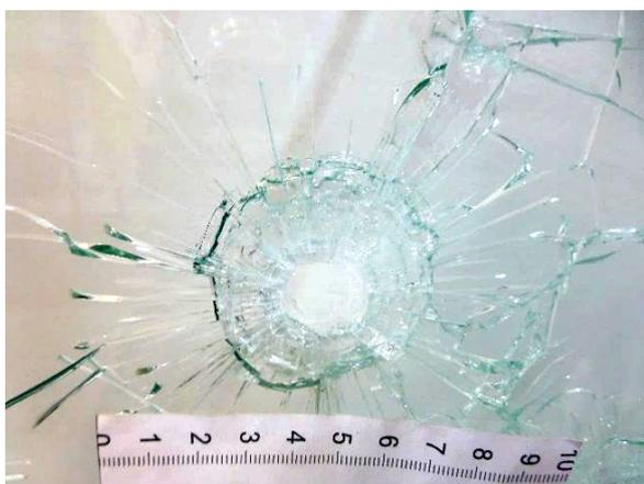
Рис. 5. Повреждение 5 стекла № 1 картечью с расходящимися от краев радиальными и концентрическими трещинами
