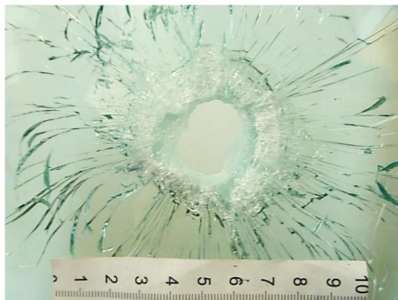
Рис. 7. Сквозное повреждение стекла № 2 с расстояния 20 м пулей с расходящимися от краев радиальными и концентрическими трещинами
