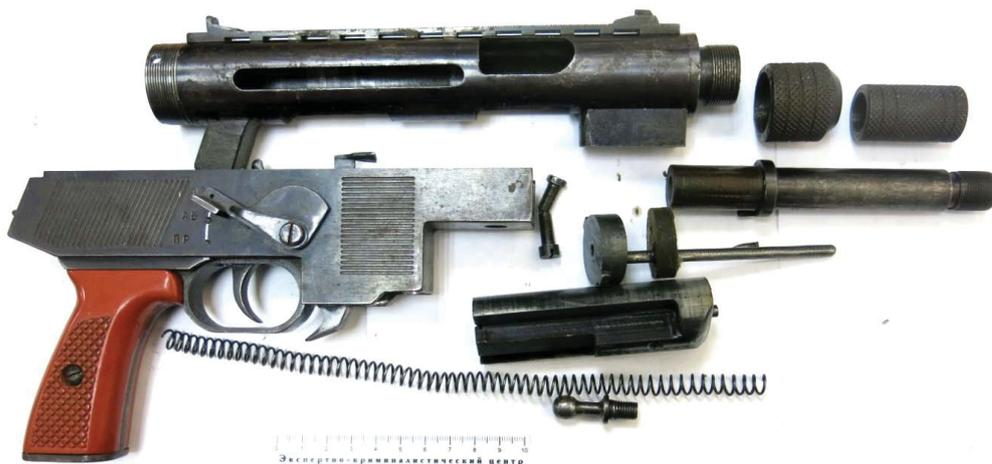
Рис. 6. 9 мм пистолет-пулемет Стрелкова в разобранном виде
