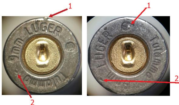
Рис. 3. Следы кончика бойка и отражателя на дне гильз, стрелянных в пистолете Glock 17, образованные при максимальном темпе стрельбы (слева) и при стрельбе с интервалом 2 с и более (справа): 1 – след кончика бойка, 2 – след отражателя
