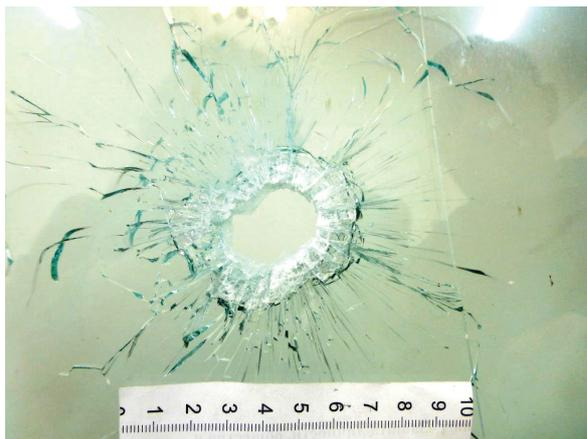
Рис. 6. Сквозное повреждение стекла № 2 с расстояния 10 м пулей с расходящимися от краев радиальными и концентрическими трещинами
