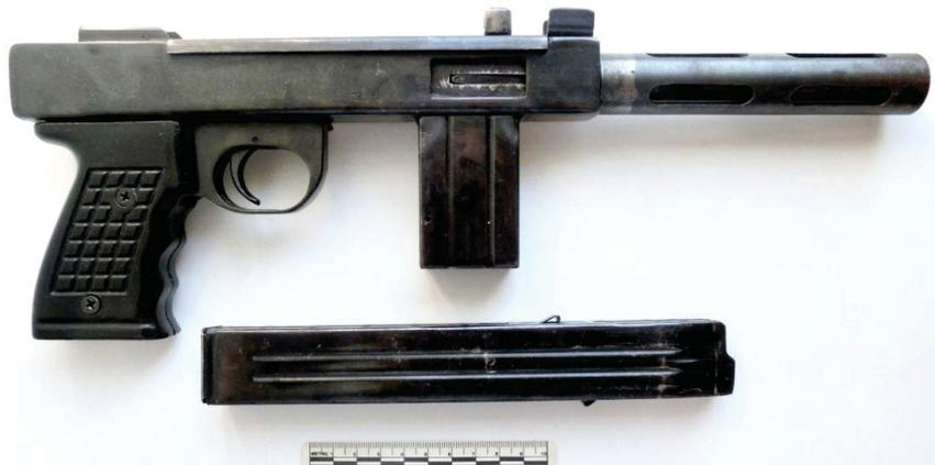
Рис. 4. Вариант конструктивно сходных с пистолетом-пулеметом К6-92 самодельного пистолета-пулемета «Борз» под патрон 9×18 мм (ПМ)
