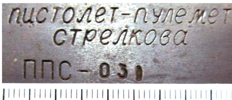
Рис. 7. Маркировочные обозначения на рамке пистолета-пулемета
