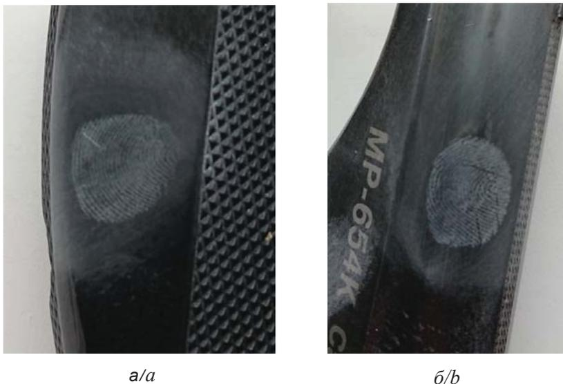
Рис. 6. Следы на пластиковой (а) и металлической (б) поверхности пистолета, выявленные порошком силикагель
