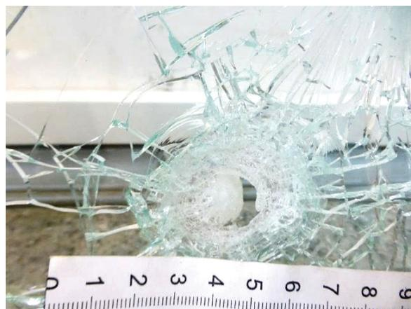
Рис. 2. Повреждение 2 стекла № 1 картечью с расходящимися от краев радиальными и концентрическими трещинами
