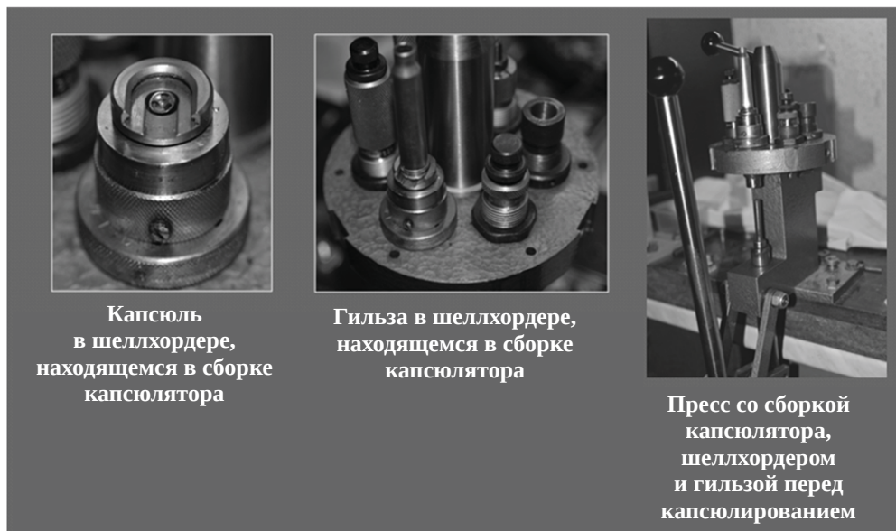
Рис. 2. Вид этапа капсюлирования, иллюстрирующий взаимное расположение следообразующего узла оборудования релоадинга (шеллхолдера) и следовоспринимающей поверхности гильзы
