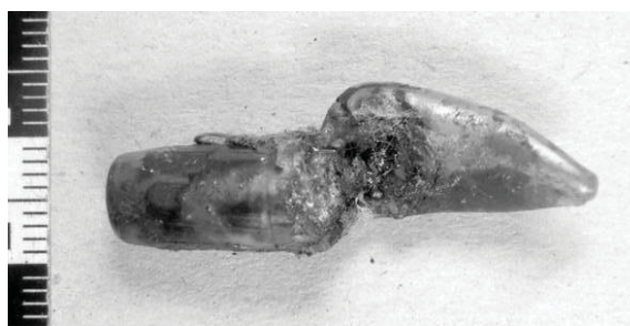
Рис. 5. Вид оболочечной специальной (трассирующей) пули 7,62 мм винтовочного патрона образца 1908 г., обнаруженной в повреждении воротника бронезилета
