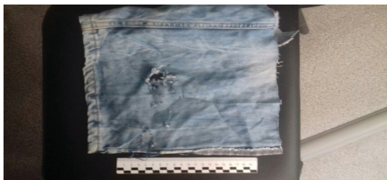
Рис. 4. Сквозное повреждение неправильной формы с рваными краями джинсовой ткани-деним
