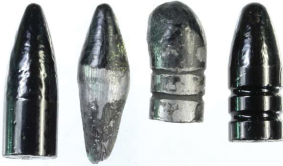
Рис. 4. Веретенообразная форма выстреленной из ружья АК-366 с ПБС пули (крайние справа и слева – виды используемых в эксперименте пуль, вторая справа – пуля, образованная при стрельбе из оружия без ПБС) Fig. 4. Spindle shape of the bullet fired from the AK-366 rifle with a silent shooting device (the rightmost and leftmost ones are the types of bullets used in the experiment, the second right is the bullet formed by firing the weapon without a silent shooting device)
