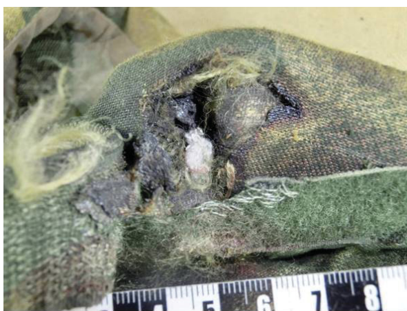
Рис. 3. Вид повреждения воротника бронезилета по нижней стороне воротника Fig. 3. The type of damage to the collar of the bulletproof vest on the underside of the collar
