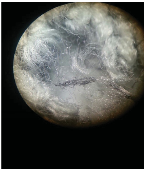
Рис. 5. Шерстяная ткань под микроскопом МБС-10 при увеличении 40 крат Fig. 5. Woolen fabric under the microscope MBS-10 at 40× magnification
