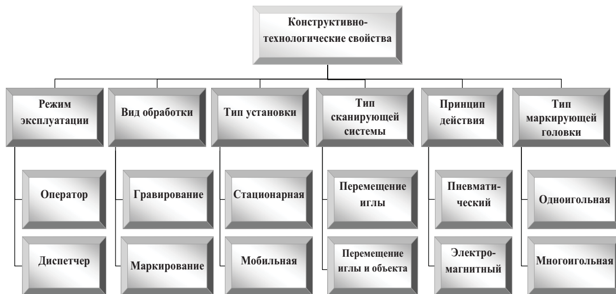
Рис. 1. Классификация свойств иглоударной маркирующей установки Fig. 1. Classification of properties of a dot peen marking installation
