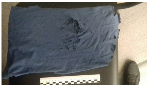
Рис. 1. Сквозное повреждение неправильной формы с рваными краями трикотажной ткани
