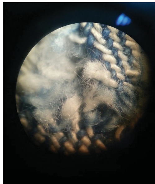
Рис. 6. Трикотажная ткань под микроскопом МБС-10 при увеличении 40 крат Fig. 6. Knitted fabric under the microscope MBS-10 at 40× magnification
