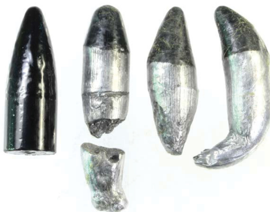
Рис. 3. Виды деформации выстреленных из ружья АК-366 с ПБС пуль и фрагментация тела одной из них (крайняя слева – один из видов используемых в эксперименте пуль) Fig. 3. Types of deformation of the bullets fired from AK-366 rifle with a silent shooting device and the fragmentation of the body of one of them (the leftmost bullet is one of the types of bullets used in the experiment)
