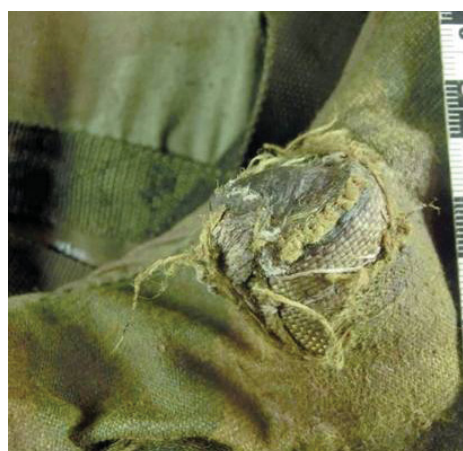
Рис. 4. Вид повреждения воротника бронезилета по верхней стороне воротника Fig. 4. The type of damage to the collar of the bulletproof vest on the upper side of the collar
