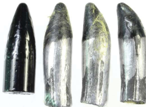
Рис. 2. Деформация тела выстреленных из ружья ВПО-209 с ПБС пуль (крайняя слева – один из видов используемых в эксперименте пуль) Fig. 2. Deformation of the body of the bullets fired from the VPO-209 rifle with a silent shooting device (leftmost bullet is one of the types of bullets used in the experiment)
