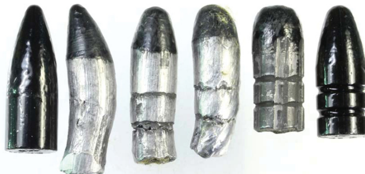
Рис. 1. Деформация тела выстреленных из гладкоствольного ружья ВПО-209 калибра .366 с ПБС пуль (крайние слева и справа – виды используемых в эксперименте пуль «Сталинградка» массой 16 г и 15 г), а также выстреленная из ружья ВПО-209 без ПБС пуля (вторая справа) Fig. 1. Deformation of the body of the bullets fired from the shotgun VPO-209 of caliber .366 with a silent shooting device (the leftmost and rightmost ones are the types of “Stalingradka” bullets with masses of 16 g and 15 g used in the experiment) as well as the bullet fired from the shotgun VPO-209 without a silent shooting device (the second bullet on the right)
