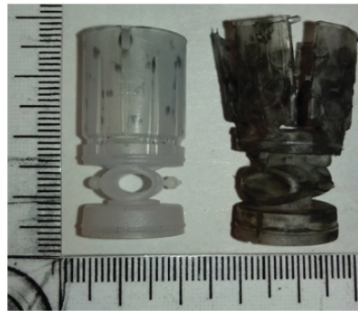
Рис. 3. Пыжи-контейнеры «Н17». Слева – пыж-контейнер, извлеченный из разряженного патрона, справа – обнаруженный после отстрела при осмотре мишеней
