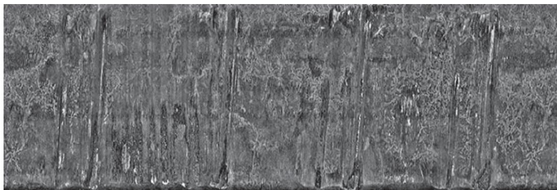
Рис. 4. Фоторазвертка ведущей поверхности выстреленной пули, подвергшейся термическому воздействию (температура 750 °C, время обжига 30 мин)
