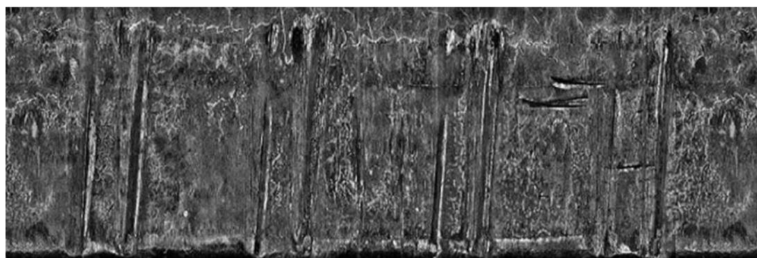
Рис. 2. Фоторазвертка ведущей поверхности выстреленной пули, подвергшейся термическому воздействию (температура 750 °C, время обжига 10 мин)
