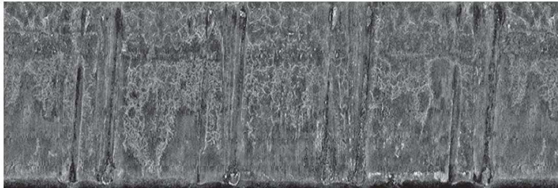
Рис. 3. Фоторазвертка ведущей поверхности выстреленной пули, подвергшейся термическому воздействию (температура 750 °C, время обжига 20 мин)
