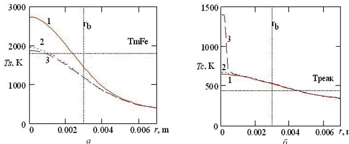
Рис. 2. Распределение температуры  $T$ , К от радиуса  $r$ , м на облучаемой поверхности (а) и на поверхности контакта оболочки с ВВ (б) в моменты времени 0,5 (1), 0,513 (2) и 0,514 (3) с при воздействии 10 кВт луча радиусом  $r_b=3$  мм. Длительность облучения 0,5 с
