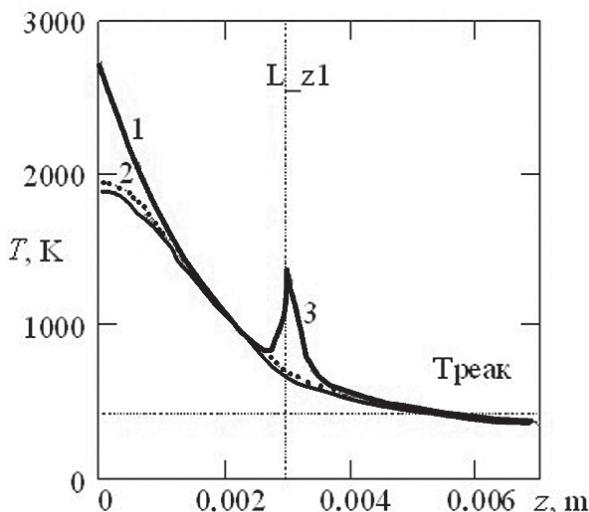
Рис. 3. Распределение температуры  $T$ , К по координате  $z$ , м на оси симметричной зоны лазерного воздействия в моменты времени 0,5 (1), 0,513 (2) и 0,514 (3) с. Мощность луча 10 кВт, радиус  $r_b=3$  мм, длительность облучения 0,5 с;  $Lz1$  – координата контакта оболочки с ВВ;  $T_{peak}$  – температура начала реакции в ВВ
