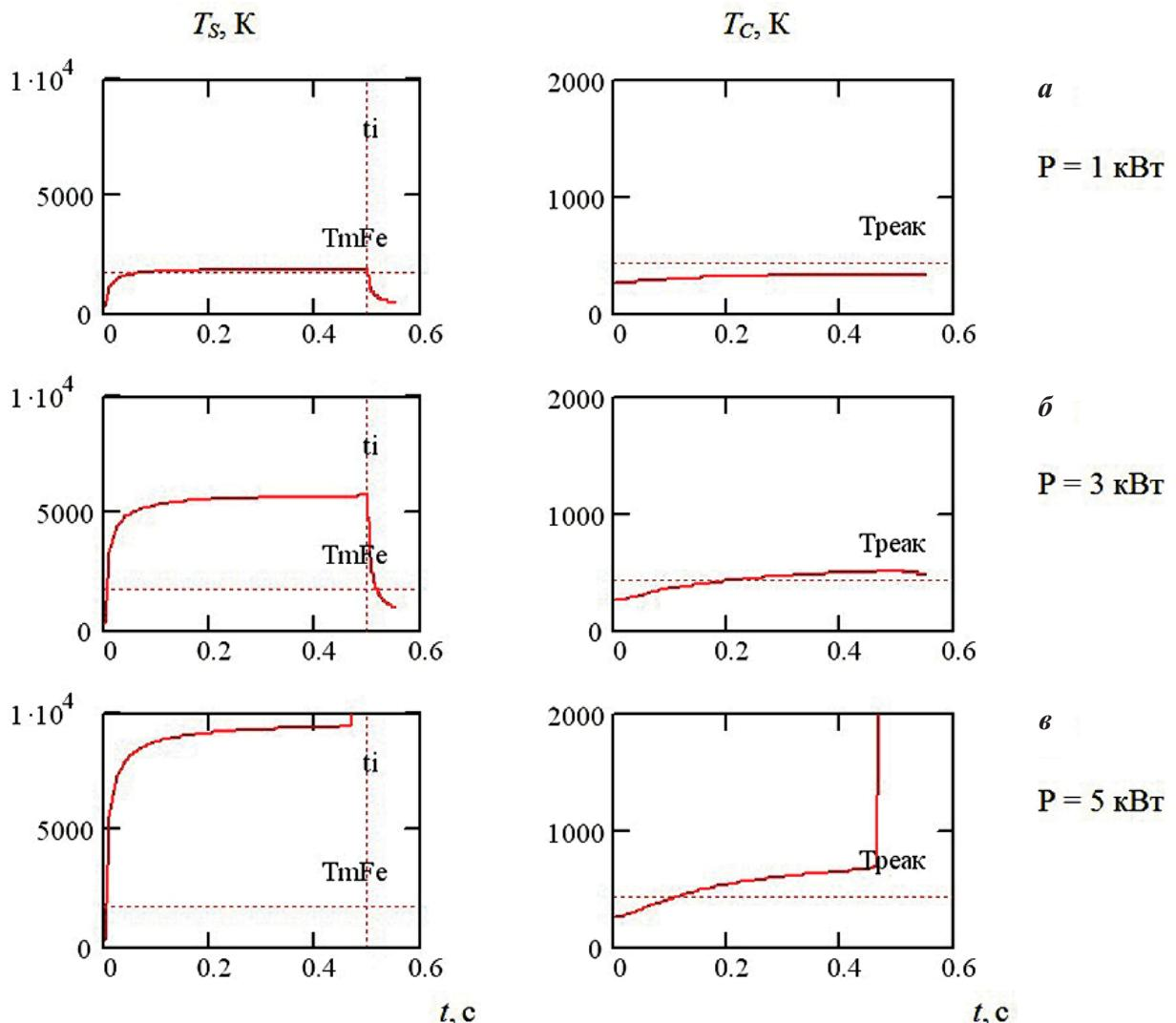
Рис. 4. Зависимость от времени  $t$ , с температуры облучаемой поверхности  $T_S$ , К и зоны контакта оболочки с ВВ  $T_C$  на оси зоны нагрева для воздействия 1, 3 и 5 кВт лазерным лучом с диаметром пятна 1,2 мм. Длина волны излучения 1.064 мкм, профиль распределения интенсивности гауссовый. Длительность облучения 0,5 с
