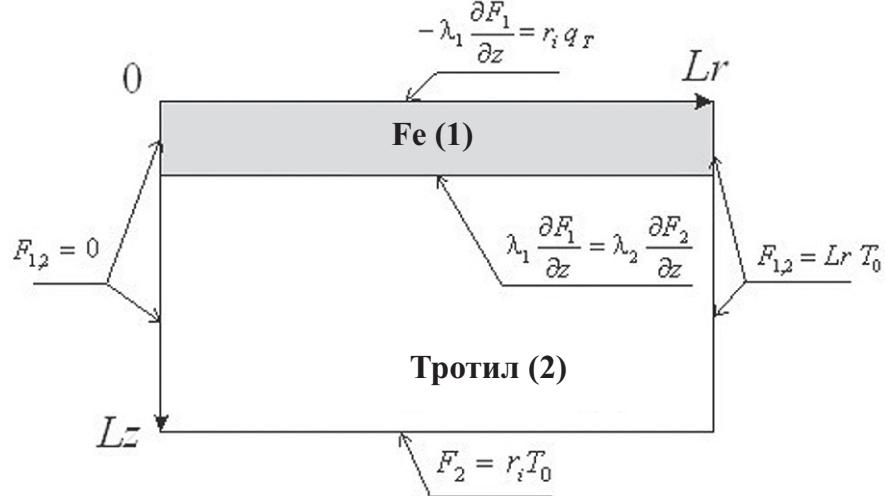
Рис. 1. Задание двуслойной расчетной области и граничных условий для двухмерной тепловой задачи в цилиндрических координатах
