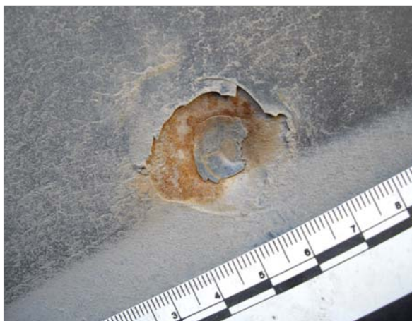
Рис. 1. Повреждение при выстреле из пистолета «Лидер» на наружной поверхности наружной панели двери легкого автомобиля «Додж-Калибер»
