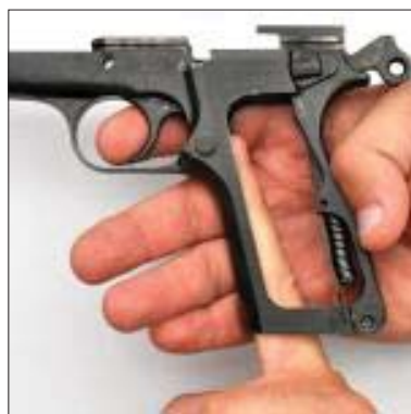
Рис. 3. Нейтрализация магазинного предохранителя
