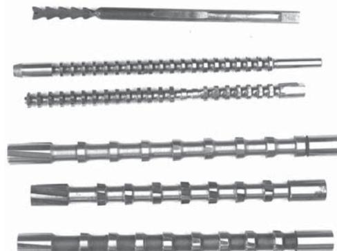
Рис. 5. Инструмент для изготовления нарезов в самодельных стволах
