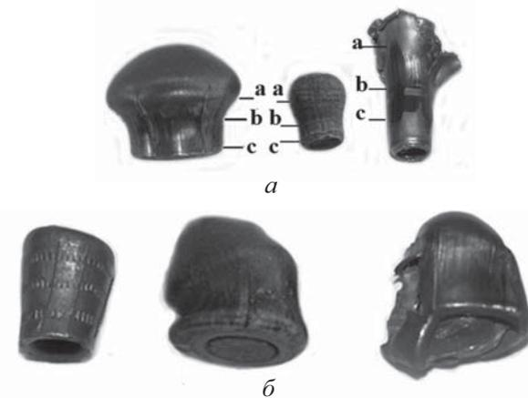
Рис. 1. Пластическая деформация пуль: *a* – приводящая к неравномерному изменению площади поверхности ведущей части на интервале высот *a-b*; *б* – приводящая к неравномерному изменению площади поверхности ведущей части по всей её длине
