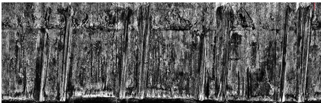
Рис. 1. Фоторазвертка ведущей поверхности выстреленной пули, не подвергшейся термическому воздействию
