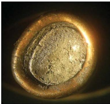
Рис. 2. Эллипсовидная деформация дна пули патрона Браунинг калибра 6,35 мм после выстрела из пистолета «Браунинг» образца 1900 г.
